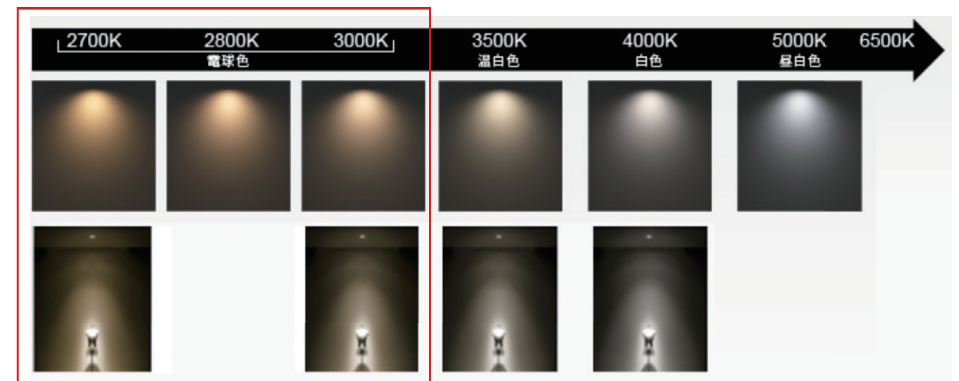
色温度・・・白色光の色味より段階分けされた単位 K(ケルビン) で示したもの
