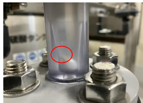
図 2. ボールカウンター部分汚れ 有赤枠内
