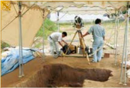
▲レーザーを使った3次元計測
