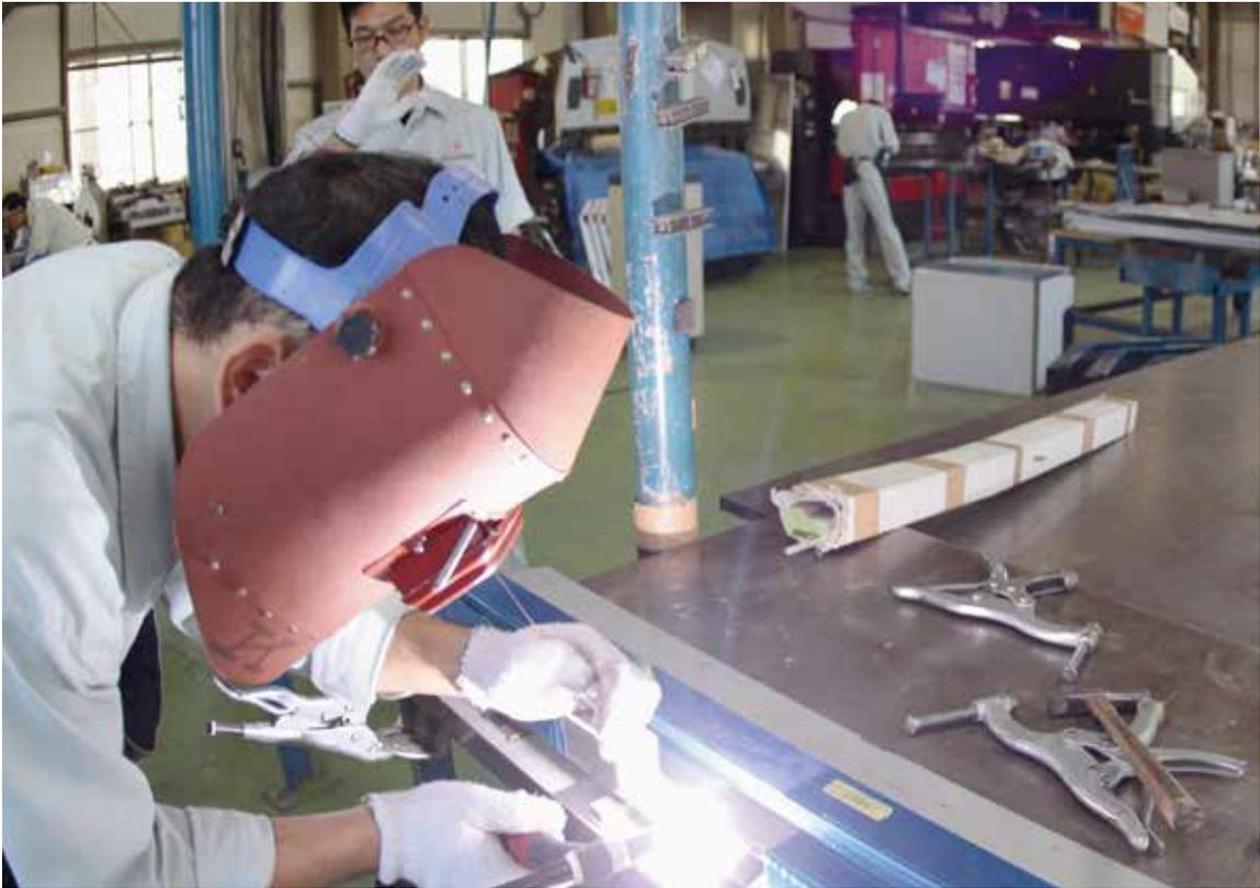
熱いずみが少なくなるよう治具を工夫してアルミの薄板を溶接している様子
