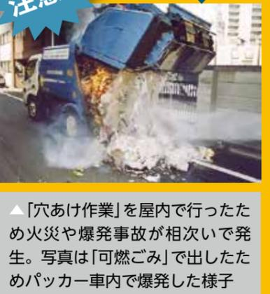
▲「穴あけ作業」を屋内で行ったため火災や爆発事故が相次いで発生。写真は「可燃ごみ」で出したためパッカー車内で爆発した様子
