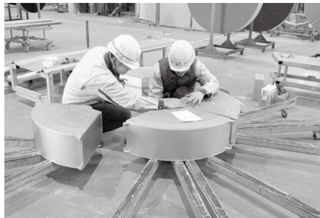
▲工場内のローター組み上げ
